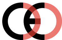
Marcatura CE contraffatta (troppo vicino)
